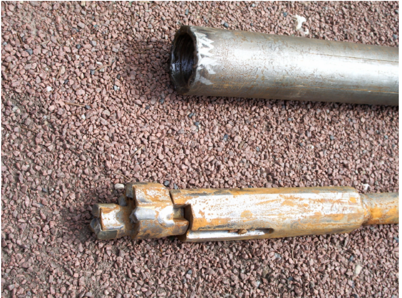
Figure 3. Matériel de forage STAF. L'outil monté sur tige, à côté du tube fendu. Vue d'ensemble et détail.
